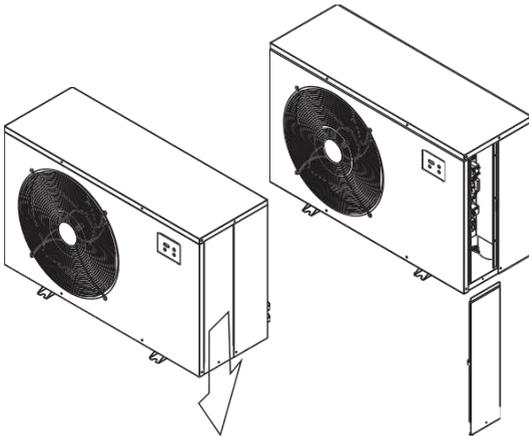
2. Abdeckung für die Montage nach oben schieben.
