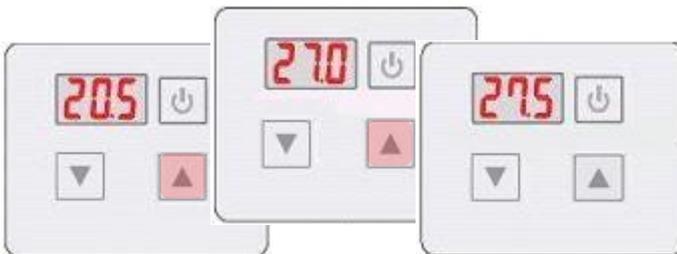
Zum Anzeigen der »Wasserauslasstemperatur« muss die Taste Tasten ▲ »UP« für 2 Sekunden betätigt werden. Die »Wasserauslasstemperatur« wird angezeigt. Nach 10 Sekunden wird die aktuelle Wassertemperatur wieder angezeigt.
