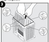
Die Platten in der folgenden Reihenfolge demontieren: 2 -> 3 -> 4.
