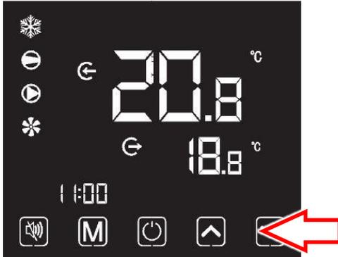
Wenn innerhalb von einer Minute der Betrieb nicht genutzt wird, wird das Display, außer der Taste »Ein/Aus«, schwarz.
