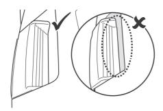
**VORSICHT!** Ersetzen Sie eine beschädigte Filterabdeckung sofort durch eine neue, bevor das Gerät erneut verwendet wird.
