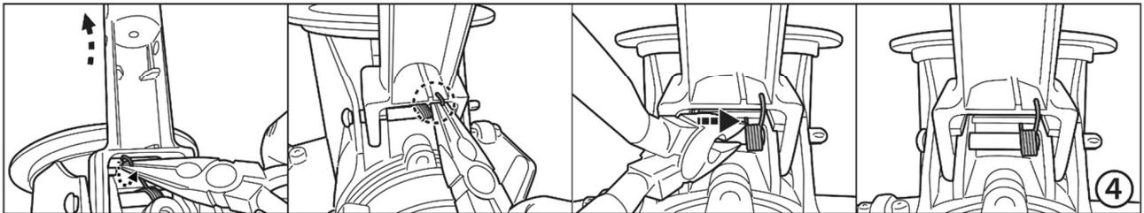
4. Ziehen Sie den Haken mit einer Zange von Unterseite des Stangenverbinders und befestigen Sie ihn dann wie abgebildet am Stangenverbinder. Führen Sie die gesamte Feder nach rechts.
