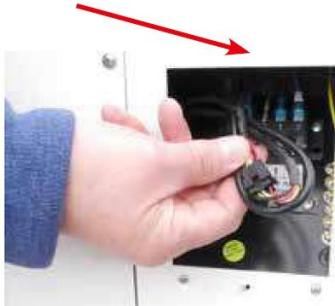
② Bestehende Verbindung durch leichten Druck auf den Entsperr-Riegel lösen
