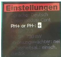
Drücken Sie die untere Taste. Die Einstellung „PH + oder PH-“ wird nun überprüft. Drücken Sie die mittlere Taste, um diese Einstellung zu aktivieren. Ein Zeichen erscheint. Drücken Sie erneut die mittlere Taste. Sie haben jetzt die Dosierung von PH- eingestellt.
