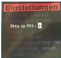
Drücken Sie die untere Taste. Die Einstellung „PH SP“ ist jetzt aktiviert. Drücken Sie die mittlere Taste, um diese Einstellung zu aktivieren. Sie sehen jetzt einen voreingestellten Wert. Jetzt können Sie den Wert mit der oberen oder unteren Taste höher oder niedriger einstellen. Danach bestätigen Sie mit der mittleren Taste. Der Wert wird jetzt nach Ihren Bedürfnissen festgelegt.
