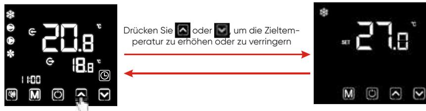
**Hinweise:** Wenn Sie unter der Temperatur Einstellung Interface kurz drücken, kehrt das System zur Haupt Interface zurück, ohne dass Änderungen gespeichert werden. Wenn 5 s lang keine Operation ausgeführt wird oder kurz gedrückt wird, wird der aktuelle Modus gespeichert und zur Haupt Interface zurückgekehrt.
