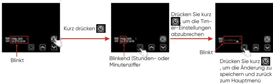
2) So brechen Sie den Zeitschalter der ersten Stufe ab: brechen Sie sowohl **ON1** als auch **OFF1** ab;
