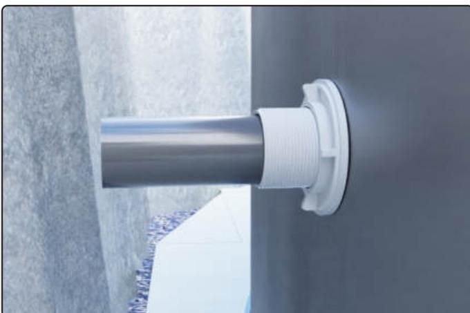
Rückseite Stahlwand: 13cm PVC Stützen einkleben
