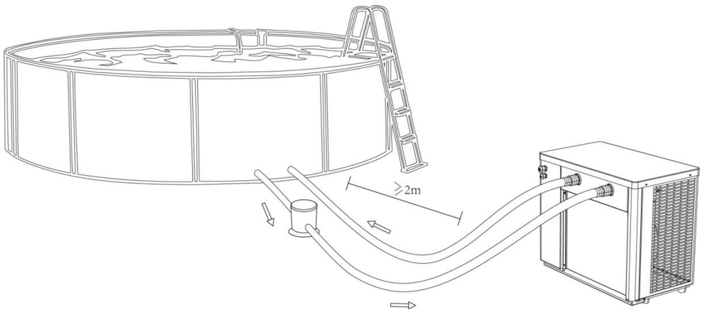
Die Schwimmbad-Wärmepumpe an die Druckseite der Filterpumpe hinter der Filteranlage und vor allen Chlorgasgeräten, Ozonisatoren oder chemischen Pumpen anschließen (s. Abb. nächste Seite).
