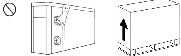
Dabei kann der Titan-Wärmetauscher der Wärmepumpe irreparabel beschädigt werden!
