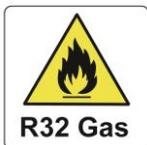
Arbeiten am Kältekreis dürfen nur von zugelassenen Fachbetrieben durchgeführt werden. Beim Befüllen mit Difluormethan (R32) kann eine unsachgemäße Behandlung zu schwerwiegenden Schäden oder Verletzungen führen.
