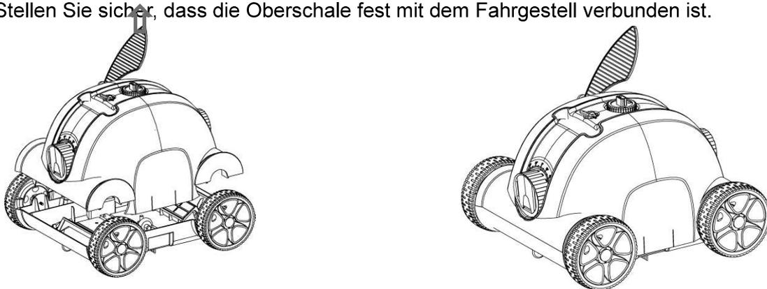
c. Setzen Sie den Bodensauger in das Wasser, wie unten auf dem linken Bild gezeigt und befreien Sie ihn komplett von jeder Luft im Innengehäuse. Gehen Sie sicher, dass der Bodensauger auf seinen Rädern steht.
