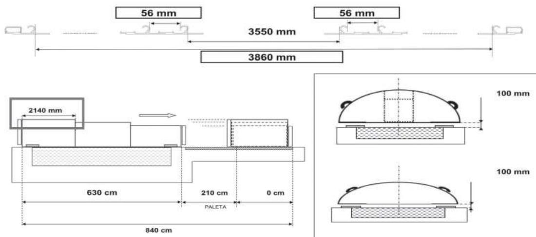
Track system installation / Montáž kolejiště / Pose des rails /
