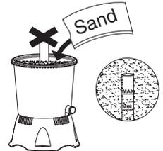
3. Füllen Sie den Sand langsam ein, damit dessen Gewicht keine Beschädigungen am Abschäumer auf der Nabe verursacht, bis die Füllhöhe zwischen den Markierungen „MAX“ und „MIN“ liegt. Füllen Sie den Sand nicht in das Rohr der Nabe ein. #20 Quarzsand 0,45-0,85mm, etwa 8,5 kg.
