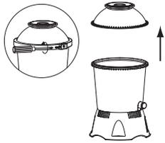
1. Verwenden Sie den Schraubenzieher und drehen Sie gegen den Uhrzeigersinn, um die Flanschklammer zu lösen und den oberen Teil des Behälters zu entfernen.
