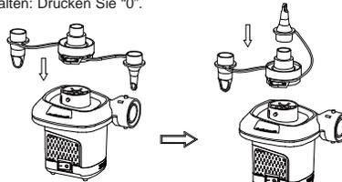
Abb. (4): ANSCHLIESSEN DER DÜSEN
