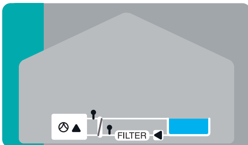
Pool mit Wärmepumpe, Wärmetauscher und Filterpumpensteuerung
