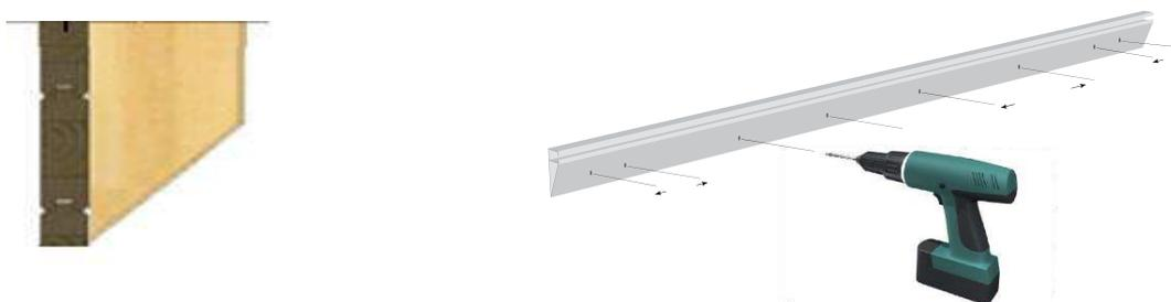
Die Leisten sollten 3 cm von den Kanten und jede 25 cm zwischen den Bohrungen gebohrt werden. Das Set beinhaltet keine Ø 4 40 mm Schrauben.
