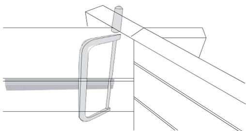
Die Ecken sollten mit einer Metallsäge abgeschnitten werden.
