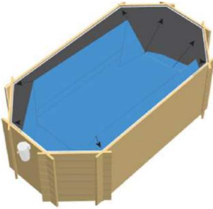
Die Bise von der Poolfolie wird in die PVC-Klemmprofileisten eingehängt, welche rund um die Holzkonstruktion am Pool angebracht worden ist.
