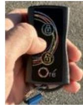
Damit sie funktioniert, muss sie auf die große Linse des Motorblocks gerichtet werden, und der Abstand zum Empfänger darf nicht mehr als 6 m betragen.
