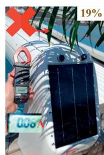
Schattenwerfende Pflanzen reduzieren die Leistung des Solarpanels. Im obigen Beispiel beträgt die Leistung des Panels 19 %. In der Nähe des Pools dürfen sich keine Gewächse befinden.
