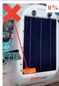
Wenn ein Objekt auf das Panel gestellt wird und mindestens eine Zelle vollständig abdeckt, erzeugt das Panel keinen Strom mehr. Seine Leistung sinkt bis auf 0 % ab. Die Benutzern darüber aufklären, dass sie das Solarpanel nicht abdecken sollten, z. B. mit einem Handtuch.
