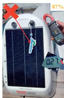
Bei voller Sonneneinstrahlung, aber mit dem Schatten des Schlüsselanhängers, Beispiel weiter oben, beträgt die Leistung des Panels nur 87 %. Der Schlüssel muss nach jeder Nutzung herausgezogen werden
