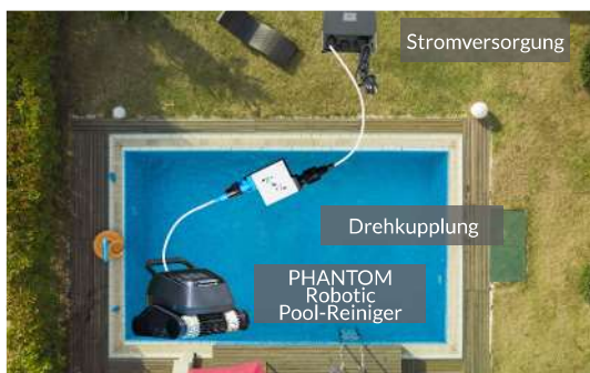
5.7 Platzieren Sie den Transformator mittig und in einem Abstand von mindestens 3,50m zwischen den beiden Enden des Pools.
