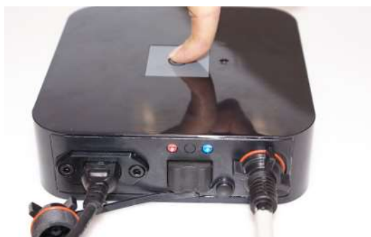
5.10 Drücken Sie die Dreh-/Stopp-Taste über dem Transformator, um den Roboter zu starten. Je nach gewählter Reinigungszeit erscheint ein rotes oder orangefarbenes Licht. Am Ende des Reinigungszyklus erlosche das rote oder orange Licht. LEDs blau + orange = 3H Zyklus aktiviert LEDs blau + rot = 3H Zyklus aktiviert
