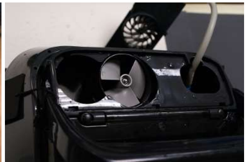
8.2 Reinigen Sie das Laufrad. 8.3 Das Schutzgitter einsetzen.
