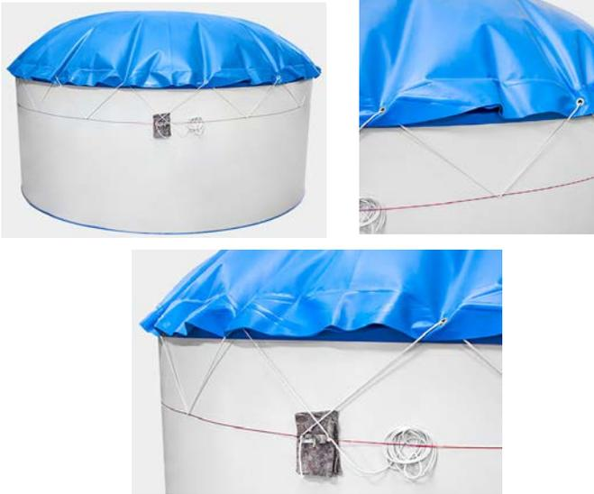
Hierbei wird ein kunststoffummanteltes Stahlseil (wie es beispielsweise auch bei PE-Abdeckungen zum Einsatz kommt) um den Stahlmantel gezogen und mittels einer Ratsche festgezurr. Dieses Seil dient dann als Haltepunkt für das nach unten zu führende und einzuhängende Gummiseil. Achten Sie darauf, zwischen Ratsche und Stahlwand einen geeigneten Unterlegschutz (zusammengefaltetes Vlies oder Pappe) zu verwenden, um ein Zerkratzen der Stahlwandbeschichtung durch die Ratsche zu verhindern.
