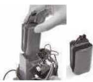
3. Öffnen Sie das Batteriefach, wo Sie die Batterieanschlüsse finden. Drücken Sie die Feder zur Seite und entnehmen Sie die Batterie. Hinweis: Wickeln Sie umgehend Isolierband um die Anschlüsse, um einen Kurzschluss durch den Kontakt zwischen zwei Drahtenden zu vermeiden.
