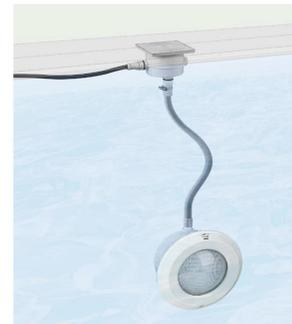
Die Kabelanschlussdose wird so montiert, dass sie oberhalb der späteren Wasseroberfläche sitzt. So wird gewährleistet, dass selbst bei einem Ausfall der Abdichtung am Kabelausgang der Nische das Wasser nicht bis nach oben in die Dose und somit an den elektrischen Anschluss gelangen kann.
