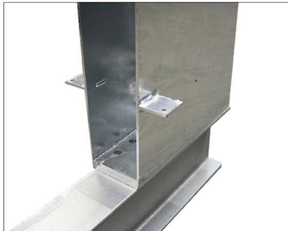
Bei Schwimmbecken aus der Serie „PURE POWER“ werden die Seitenstützen von oben auf den Grundträger verschraubt. Zusätzlich verfügen die Seitenstützen über Befestigungslaschen zur späteren Fixierung der Bodenschiene. **Beim Einsetzen der gesamten Stützkonstruktion ist darauf zu achten, dass die Unterkante der Befestigungslaschen bündig zum geplanten Schwimmbeckenboden sitzt.**
