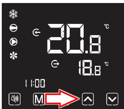
Um sich das »Timer« Symbol einmalig anzeigen zu lassen, werden die Tasten »nach unten« und »nach oben« gleichzeitig gedrückt. Nun befindet man sich in dem Uhreinstellungs-menü.
