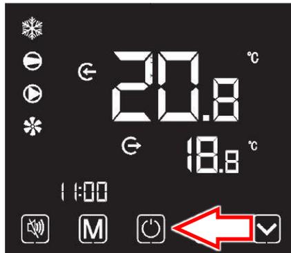
Wenn innerhalb von einer Minute der Betrieb nicht genutzt wird, wird das Display, außer der Taste »Ein/Aus«, schwarz.
