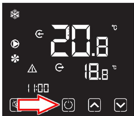
Bei zwei oder mehr Fehlern werden die Tasten »nach oben« oder »nach unten« betätigt, um sich die Fehler anzeigen zu lassen. Auch hier wird anschließend die Taste »Ein/Aus« gedrückt.
