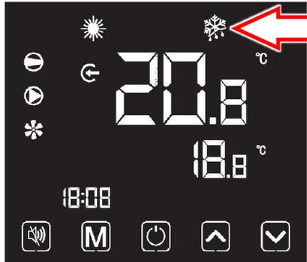
Nach dem Abtauen, stellt sich die Schwimmbad-Wärmepumpe automatisch auf den Heiz- oder Automatikmodus um.
