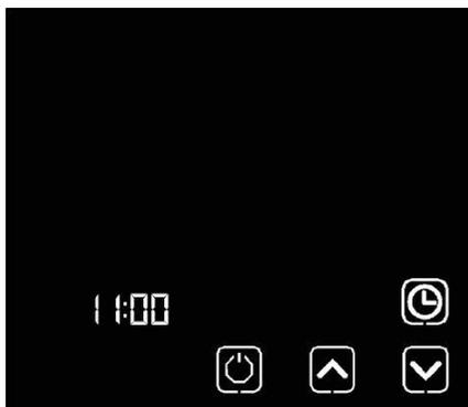
Zum Einstellen der »Timer-Uhrzeit« muss zunächst die Taste »Timer« für 2 Sekunden betätigt werden. Nun kann man zwischen den Uhrzeiten »Timer-ON1-Uhrzeit«, »Timer-OFF1-Uhrzeit«, »Timer-ON2-Uhrzeit« und »Timer-OFF2-Uhrzeit« wählen.
