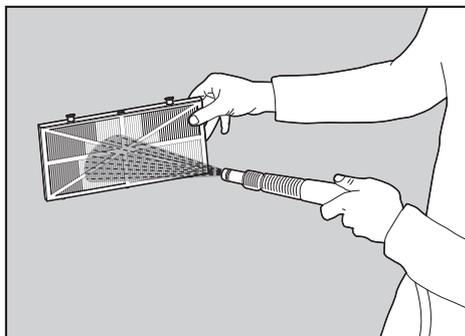
Reinigen Sie die Filter mit einem Wasserschlauch.
