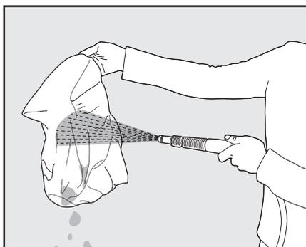
Reinigen Sie den Filterbeutel mit einem Wasserschlauch.
