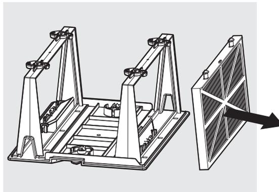
Öffnen Sie die Schnappverschlüsse und entfernen Sie die Filter.
