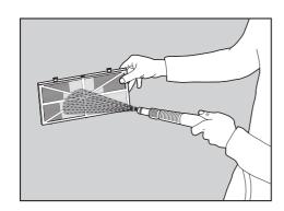
Reinigen Sie die Filter mit einem Wasserschlauch.
