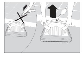
ZIEHEN SIE DEN POOLREINIGER NICHT AM KABEL AUS DEM POOL.
