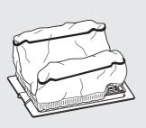
Bodenklappe und Filterbeutel
