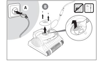
Setzen Sie die Flügelrad-Abdeckung schräg auf, so dass sich die Kerbe am zweiten Ring der Feder befindet. Drücken Sie die Flügelrad-Abdeckung in Richtung Feder herunter und drücken Sie sie an ihren Platz. Ziehen Sie die Schrauben wieder fest.
