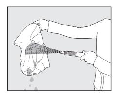
Reinigen Sie den Filterbeutel mit einem Wasserschlauch. Wir empfehlen, den Filterbeutel regelmäßig in der Waschmaschine unter Verwendung des Schonwaschgangs zu waschen. Reinigen Sie die Bürsten regelmäßig mit einem
